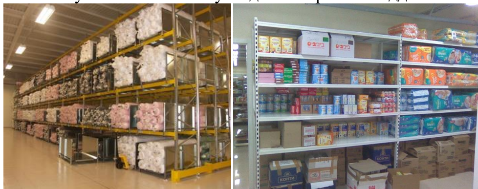
а) кипные товары б) в мелкой товарной упаковке Рисунок 3 - Хранение товаров на поддонах в стеллажах
