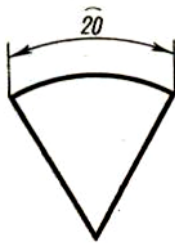
Рисунок 4 – Нанесение размера дуги
