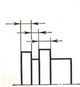
Рисунок 8 – Нанесение стрелок на размерной линии недостаточной длины
