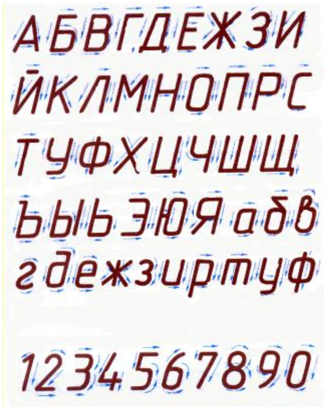
Рисунок 1. Начертание прописных и строчных букв и цифр.
