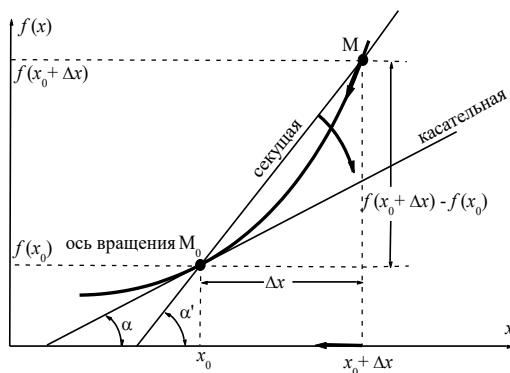
При  $\Delta x \rightarrow 0$  точка  $M$  начинает двигаться к точке  $M_0$ . При этом вся секущая будет поворачиваться около точки  $M_0$  и в пределе она превратиться в касательную к точке  $M_0$ . Угол  $\alpha'$  при этом перейдет в угол  $\alpha$ , который эта касательная образует с осью  $x$ . Поэтому можно утверждать, что
