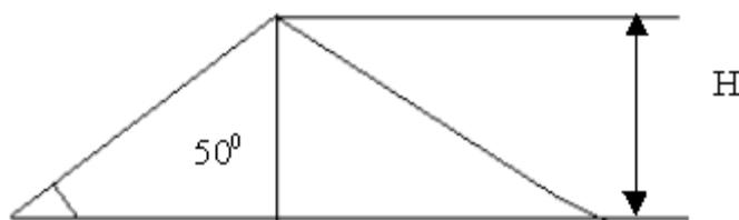
Объем кучи угля  $V = \frac{1}{3} \pi R^2 H$ . Так как  $R = H \cdot \operatorname{ctg} \alpha$ , то  $V = \frac{1}{3} \pi H^3 \operatorname{ctg}^2 \alpha$ , а масса кучи угля составляет:  $m = \frac{1}{3} \rho \pi H^3 \operatorname{ctg}^2 \alpha$ . Число железнодорожных платформ определяем по формуле  $n = \frac{m}{25}; n = \frac{1}{3 \cdot 25} \rho \pi H^3 \operatorname{ctg}^2 \alpha = \frac{1}{75} 1,3 \cdot 3,14 \cdot 7,5^3 \operatorname{ctg}^2 50^\circ \approx 16$  (пл.).
