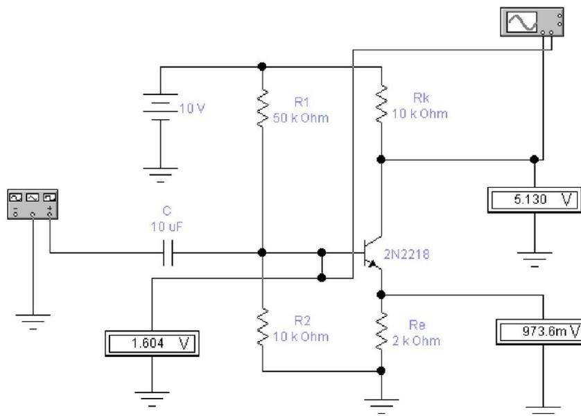
Рис. 14. - Схема для исследования работы усилителя напряжения
