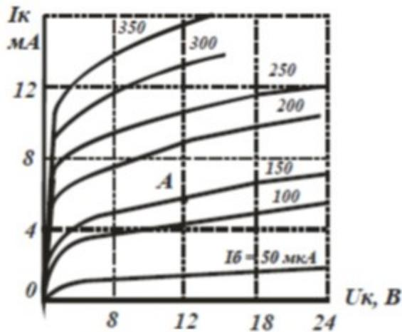
По семейству выходных характеристик транзистора КТ339А в схеме с общим эмиттером (рис. ) определить ток базы  $I_B$  и напряжение на коллекторе  $U_K$  в рабочей точке А, в которой ток коллектора  $I_K = 6$  мА, а мощность, рассеиваемая на коллекторе  $P_K = 72$  мВт.
