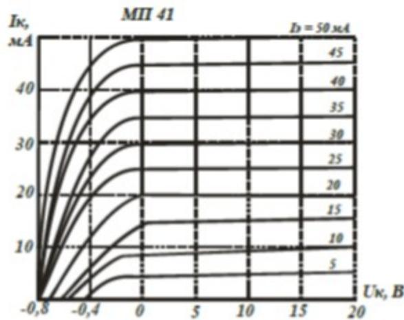
Для транзистора МП41 в схеме с общей базой, семейство выходных характеристик которого приведено на рис. 4. 6, определить в рабочей точке А ток эмиттера  $I_E$ , ток коллектора  $I_K$  и напряжение на коллекторе  $U_K$ , если мощность потерь на коллекторе  $P_K = 150$  мВт, а сопротивление постоянному току  $R_0 = 402$  Ом.
