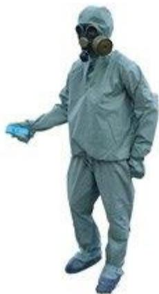
Легкий защитный костюм изготовлен из прорезиненной ткани и состоит из рубахи с капюшоном 1, брюк 2, сшитых заодно с чулками, двухпалых перчаток 3 и подшлемника 4. Кроме того, в комплект костюма входят сумка 5 и запасная пара перчаток. Вес защитного костюма около 3 кг.
