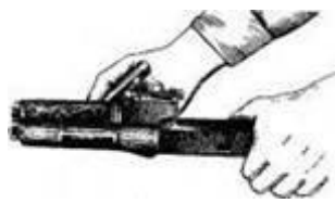
Рисунок 7 – Отделение газовой трубки со ствольной накладкой
