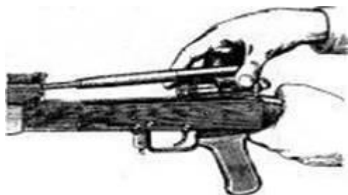
Рисунок 5 – Отделение затворной рамы с затвором
