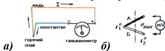
Рис. 2.2. Принцип действия термопары (а); его схема (б).
