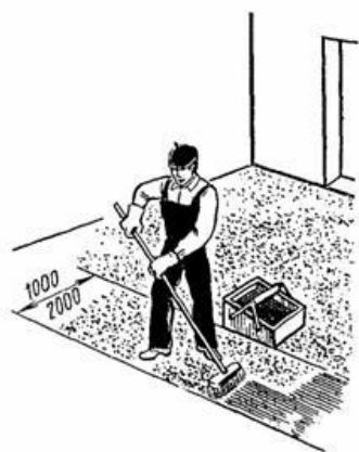
Рис. 72. Нанесение восковой мастики щеткой
