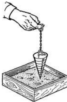
Рис. 15. Проверка пластичности раствора эталонным конусом
