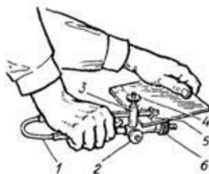
Рис. 9. Приемы резки керамических плиток с помощью роликового плиткореза: 1 - стальная пластинчатая пружина, 2 - винт-фиксатор, 3 - направляющий уголок, 4 - регулировочный винт, 5 - резец, 6 - резиновый ролик
