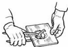
Рис. 13. Расширение отверстия кусачками
