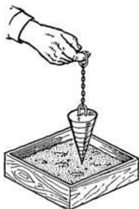
Рис. 15. Проверка пластичности раствора эталонным конусом
