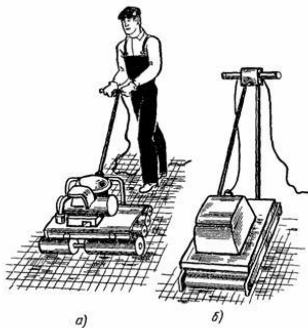
Рис. 35. Вдавливание (припрессовывание) свежеложенных плиток виброкатком (а) и виброплитой (б)
