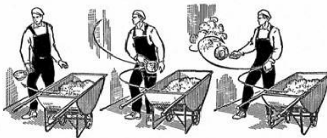
Рис. 92. Приемы нанесения раствора отделочным ковшом
