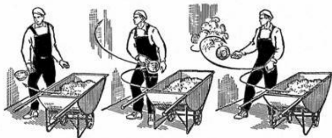
Рис. 92. Приемы нанесения раствора отделочным ковшом
