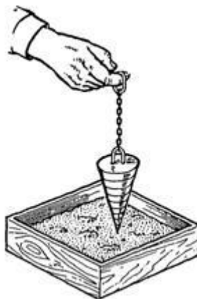
Рис. 15. Проверка пластичности раствора эталонным конусом
