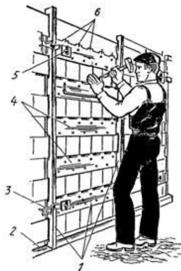
Рис. 102. Облицовка горизонтальными рядами с помощью шаблона: 1 - щит шаблона, 2 - опорный брусок, 3 - рейкодержатель, 4 - промежуточные рейки, 5 - опорный винт, 6 - стальные пластинки
