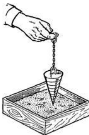
Рис. 15. Проверка пластичности раствора эталонным конусом
