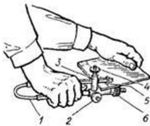
Рис. 9. Приемы резки керамических плиток с помощью роликового плиткореза: 1 - стальная пластинчатая пружина, 2 - винт-фиксатор, 3 - направляющий уголок, 4 - регулировочный винт, 5 - резец, 6 - резиновый ролик
