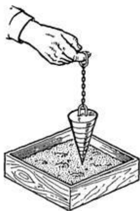
Рис. 15. Проверка пластичности раствора эталонным конусом
