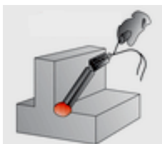
Рис. 5. Сварка двумя электродами, в двух электрододержателях
