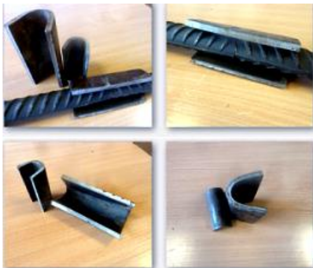
Рис. 13. Ванночки для сварки арматуры
